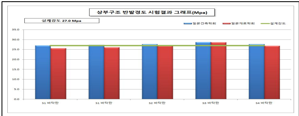
【그림 23.4.2】 영천방향 상부구조 반발경도시험 측정결과
